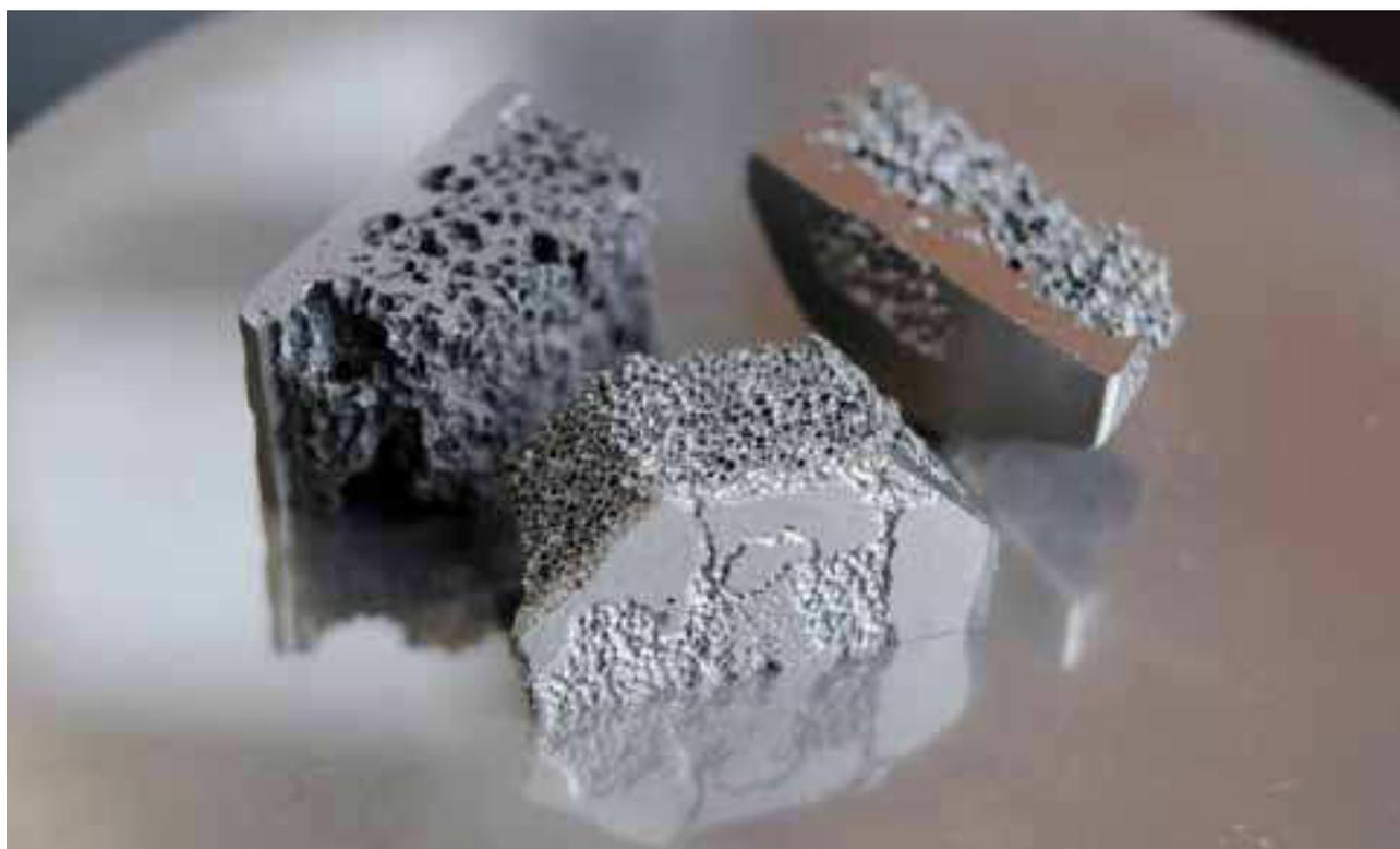
■ Esempi di materiali strutturati a base di **ceramici** ultrarefrattari da utilizzare in ambito spaziale e in grado di resistere a temperature superiori ai 1600°C. L'accoppiamento di materiale poroso interno con uno strato denso esterno permette un alleggerimento della struttura, con minore impatto sul peso complessivo del componente finale
