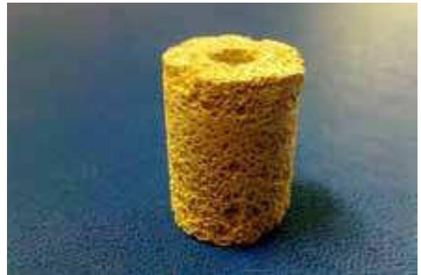
vini, latte e succhi di frutta; filtrazione di sangue e liquidi fisiologici; filtrazione di batteri e virus; separazione di gas. I materiali ceramici hanno ottime proprietà meccaniche, inerzia chimica, possibilità di sterilizzazione e, soprattutto, la possibilità di controllare la porosità, dai nano-pori per la separazione molecolare di gas, ai micro-pori per i liquidi, a pori millimetrici per filtrare metalli fusi.
